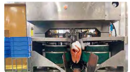
三枚卸機 ※頭を落とした魚体を通すことで、魚体を3枚に卸します。
