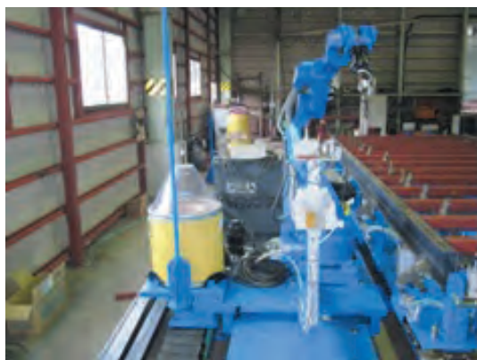
溶接ロボット
