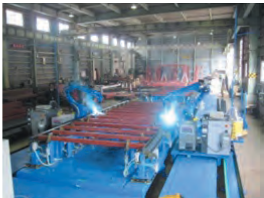
自動溶接状況
