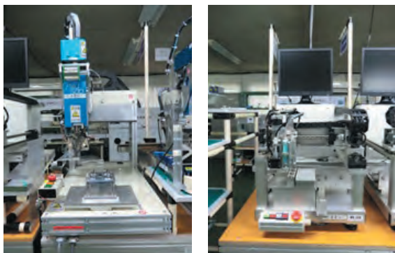
はんだ付けロボット・超小型簡易チップ搭載機
